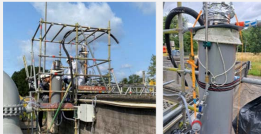
Figuur 13 Opzet 2a naast de cascadebak (links) en in meer detail de zeven boven op een vat met een 10 µm net (rechts)
